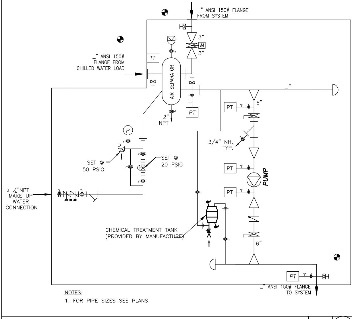
TYPICAL WATER PUMP PACKAGE PIPING DIAGRAM
